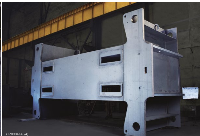
Diese 80 t schwere Stahlkonstruktion wurde bei der von Schaewen Polska Sp. z o. o. verschweißt.
