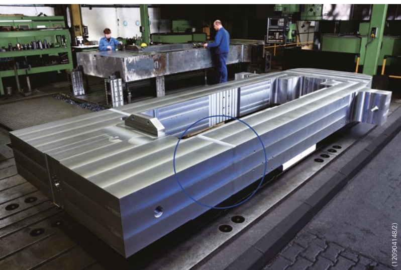
Die fertige Engspaltschweißung am Bauteil
