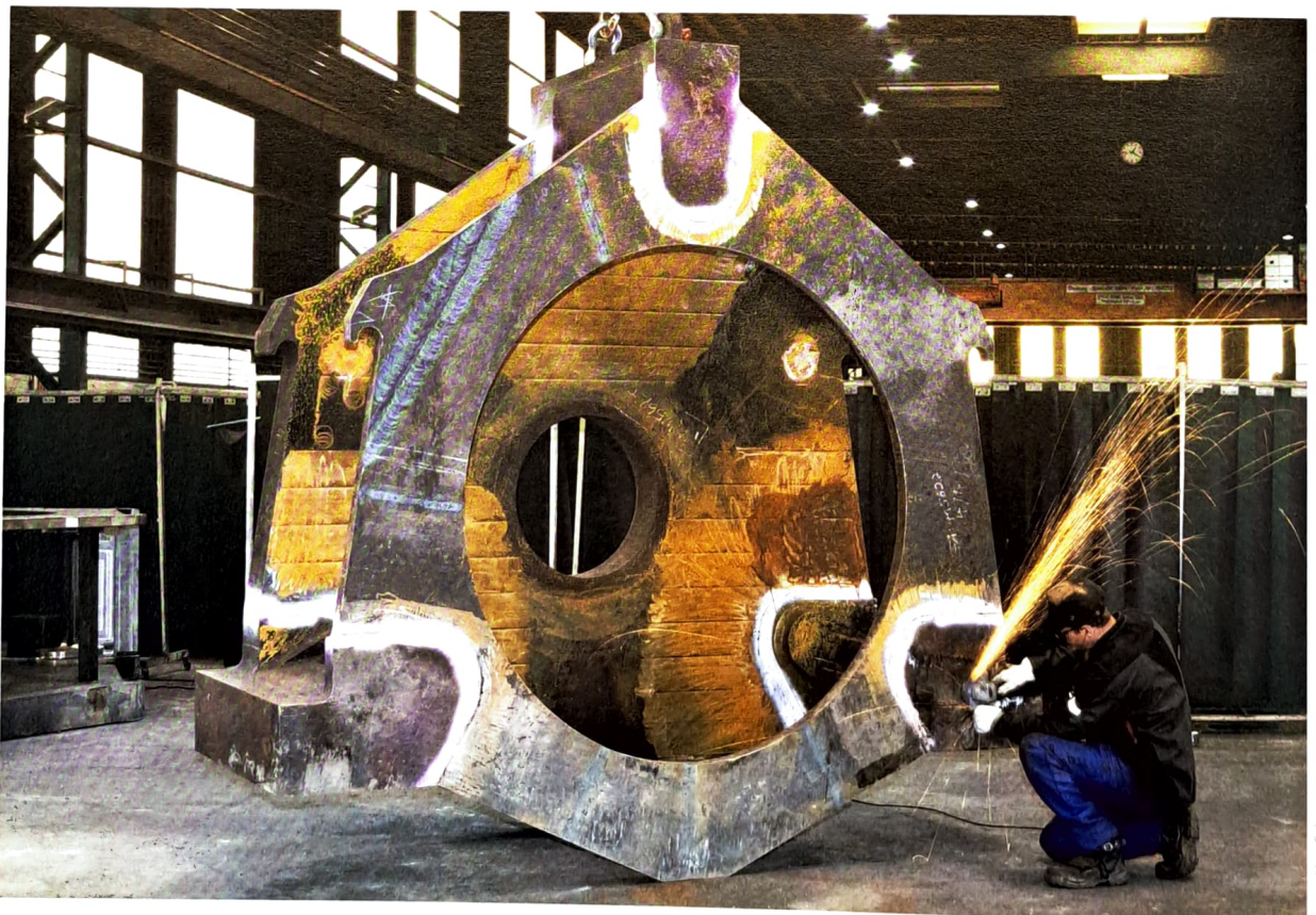
Die fertigen Gehäuse verfügen über ein gewaltiges Stückgewicht von rund 14 000 Tonnen.
