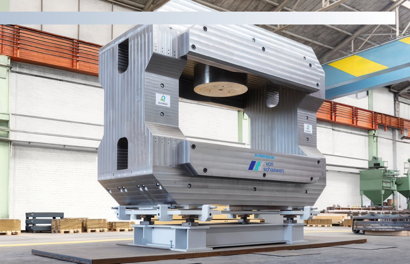
Das in Essen gefertigte Magnetjoch vor dem Transport nach Darmstadt. Die Konstruktion besteht aus 16 Einzelteilen mit einem Gesamtgewicht von 153 t.
